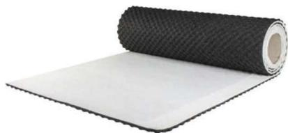
Materassino isolante acustico bugnato per esterno resistente all'umidità, composto da elastomero poliuretano composito con lato inferiore profilato e lato superiore laminato geo-tessile.
